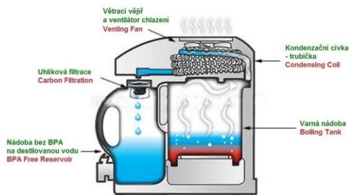
SCHÉMA DESTILÁTORU VODY
